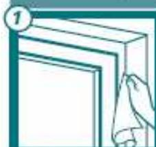
Reinigung des Blendrahmens mit Ethanol (Alkohol) und entfernen von PU/Montageschaumresten und -überständen von der Fensterlaibung. Alle Untergründe der Fensterlaibung müssen eine ausreichende Dichtigkeit und Tragfähigkeit aufweisen. Nicht tragfähige Untergründe reinigen und/oder mit Primer AB vorbehandeln.
