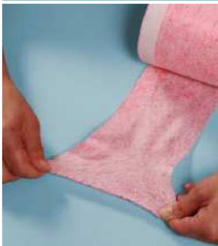
Hanno®-Folienband FA-D besteht aus einer Kombination von Vlies und einer dampfdiffusionsoffenen Funktionsmembrane. Hanno®-Folienband FI-D aus einer dehnfähigen, dampfdiffusionsdichten Folien-Vlies-Kombination. Beide Bänder verfügen über einen selbstklebenden Befestigungsstreifen. Dieser ermöglicht einen sehr einfachen, komplett verdeckten Einbau des überputz- und überstreichbaren Folienbandes.
