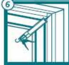
Schnittkante und Ecke mit einem geeigneten Dichtstoff verschließen. Hierzu können Sie sowohl Hanno®-Universaldichtmasse als auch Hanno® Dicht- und Klebmasse MS verwenden.
