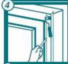
Hanno®-Sanierungsleiste zunächst spannungsfrei am Blendrahmen verlegen und mit Andruckrolle nacharbeiten.
