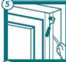
Anschließend Hanno®-Sanierungsleiste spannungsfrei an der Fensterlaibung anbringen und mit Andruckrolle nacharbeiten.
